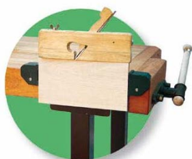
Spannen mit Steckspannbacken – vor bzw. auf der Werkbank
